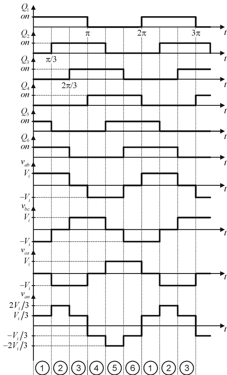
Таласни облик фазног напона  $v_{an}$  може се добити анализом таласних облика у прва три интервала рада инвертора, користећи притом еквивалентне шеме које важе у овим интервалима. У првом интервалу рада важи:
